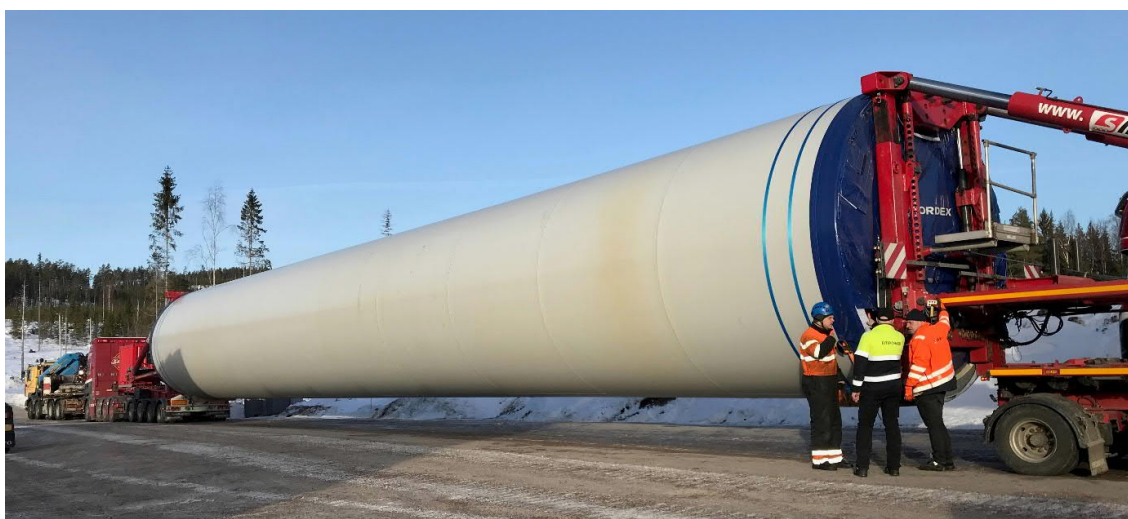
FIGUR 23. TRANSPORTSLÄP MED TORNDEL.
