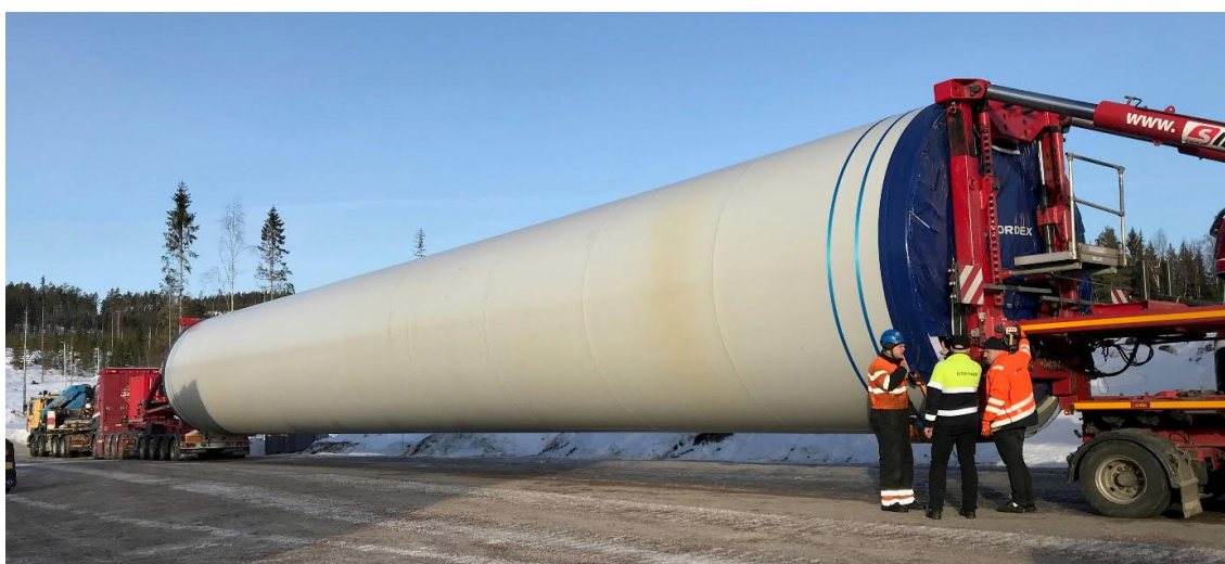
FIGUR 23. TRANSPORTSLÄP MED TORNDEL.
