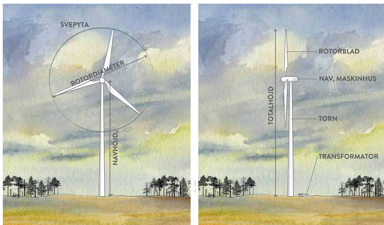
FIGUR 5 Principskiss av vindkraftverkets delar.
